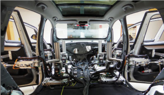
4 icdt-Einheiten eingebaut / installation of 4 icdt
