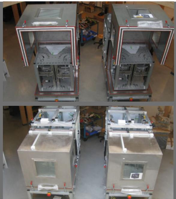
Mit dem Pedalprüfstand können Gas-, Kupplungs- und Bremspedale automatisch geprüft werden.
