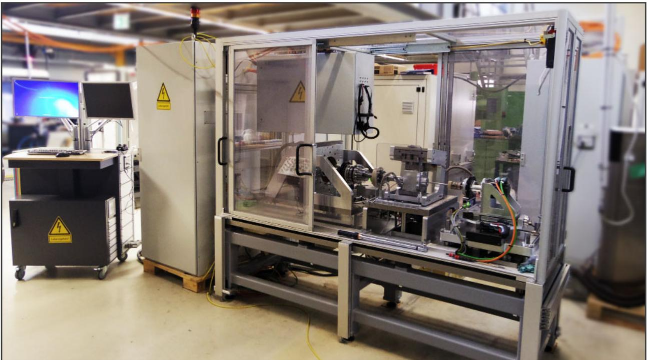
Mit diesem Prüfstand können Sie Getriebe unterschiedlicher Art testen.
