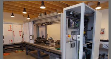
Der Lenkungsprüfstand ist ein Messprüfstand für mechanische und elektromechanische Lenksysteme, die an den original nachempfundenen Aufnahmepunkten verschraubt werden. Der Prüfstand bildet somit die Aufnahmepunkte nach, die auch im Fahrzeug verwendet werden. Die Krafteinleitung der Lenkbewegung erfolgt über ein Antriebssystem und wird unterstützt über eine angesteuert-simulierte Fahrzeugelektronik mit Prüflingslenkunterstützung.
