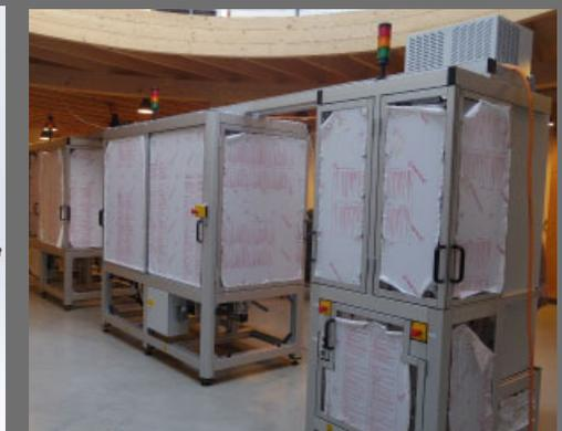
Mit diesem Prüfstand können Sie die Festigkeit von bis zu 4 Bremssätteln (Scheibenbremssystem) und 2 elektrischen Parkbremsen testen.
