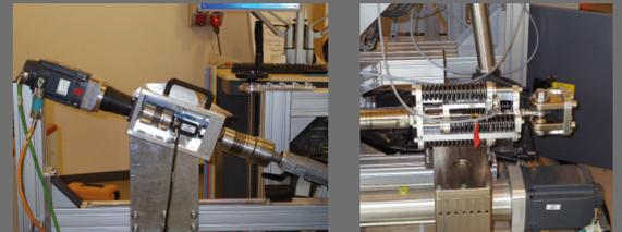
Dieser Prüfstand simuliert die Belastung an elektromechanischen oder rein manuellen Lenksystemen in Einparksituationen.
