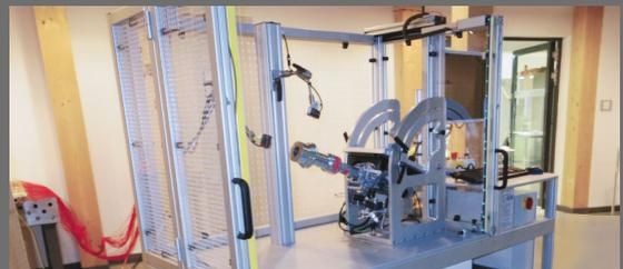
Der Prüfstand kontrolliert die Verstellcharakteristik der Lenksäule bei Nutzung der elektronischen Verstellung.
