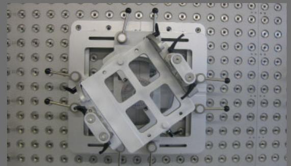
Der Prüfstand dient zur Durchführung von Belastungstests an Bowdenzügen.
