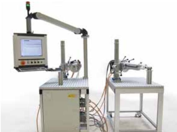
Der Schließzylinderprüfstand dient der Ermittlung sowie dem Test von Linearkräften und Drehmomenten, die auf den Fahrzeugschlüssel und das Fahrzeugschloss einwirken.
