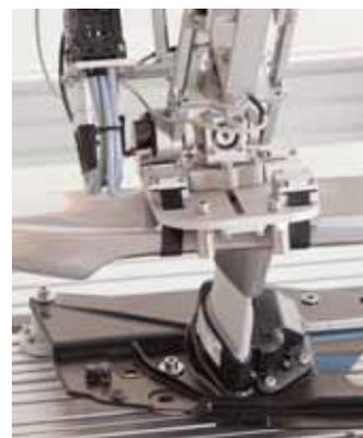
Mit diesem Prüfstand können Heckspoiler unterschiedlichster Bauform, Baugröße und Bauarten individuell getestet werden.
