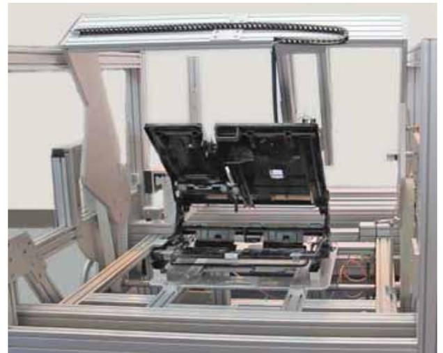
Der Sitzprüfstand von Kübrich ist eine komplexe Kombination verschiedener Testabläufe zum Testen am Fahrzeugsitz. Der Prüfstand wird für jeden Sitz-Prüfling individuell konzipiert und angepasst.
