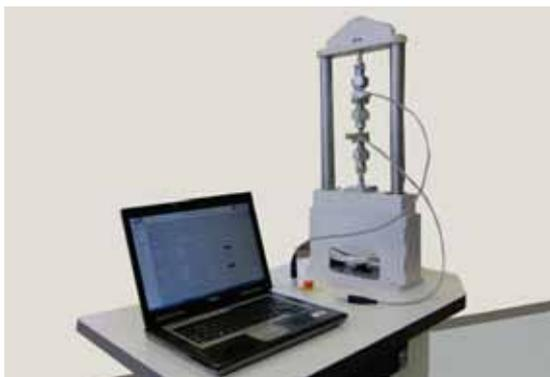
Der Prüfstand zur Messung der Kraftmomente bei diversen Bauteilen.
