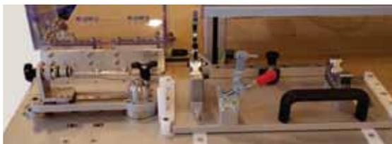
Der Prüfstand zur Messung der Beugemomente am Kreuzgelenk von Lenkspindeln unterschiedlicher Baureihen.
